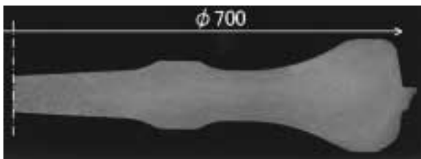
写真3 Ti-6246 プロセス鍛造ディスクのマクロ組織 Photo 3 Macrostructure of processed disk forging
