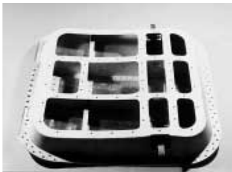
Material : D357.0-T6 alloy Size : 620mm × 600mm × 80mm, 1.5mmt
