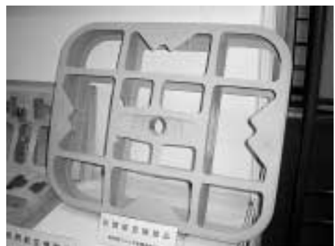
写真2 B737ハッチドアアルミニウム鋳物 Photo 2 Hatch door aluminum casting
