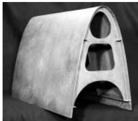
Material : D357.0-T6 alloy Size : 600mm × 400mm × 600mm, 2.0mmt
