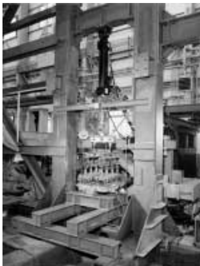
写真5 ドア鋳物実体試験状況 Photo 5 Testing of door casting
