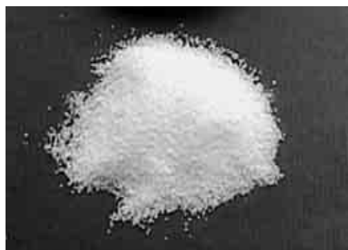
図 2 蓄熱材料 (エリスリトール)
