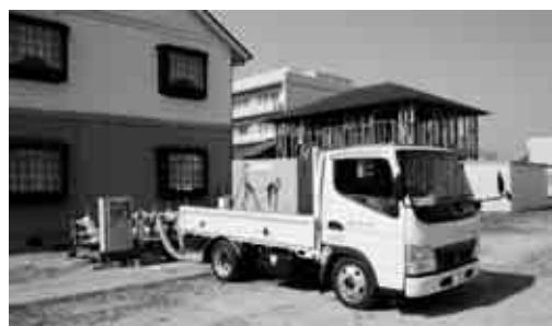
図 4 小型蓄熱装置と冷熱転換試験装置 (熱輸送量 250MJ)
