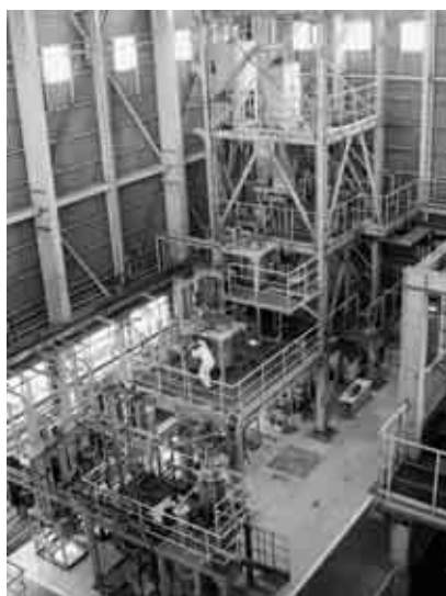
写真1 0.1t/d 連続式ハイパーコール製造試験装置(BSU) Photo 1 Photograph of 0.1t/d hyper-coal BSU
