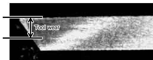
図1 マージン摩耗の測定方法 Fig. 1 Measuring method of margin wear
