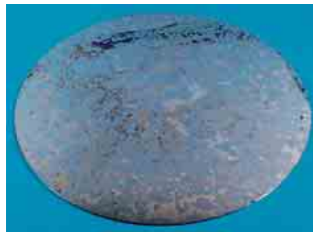
写真1 銅を0.2%含むフッ酸水溶液に3分浸漬したウェーハ Photo 1 Wafer immersed in HF-solution containing 0.2% of Cu for 3 min
