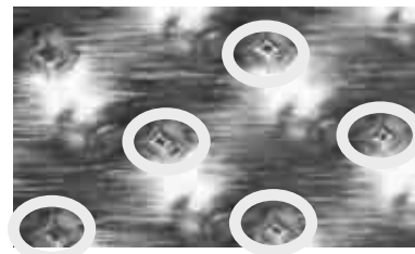
写真3 アルミ箔微細孔の拡大写真 Photo 3 Micro holes in aluminum foil
