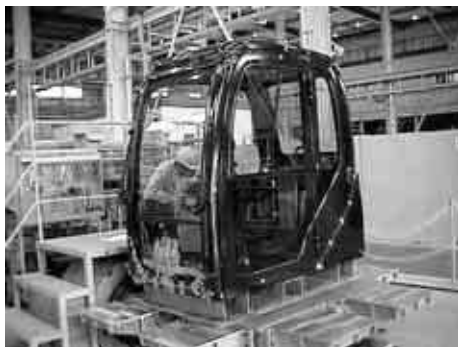
写真2 キャブ加振テスト Photo 2 Oscillation test of cabin
