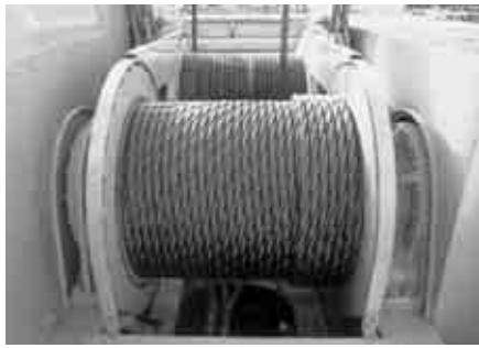
写真2 ワイヤロープの整列巻き Photo 2 Ordered winding of wire rope
