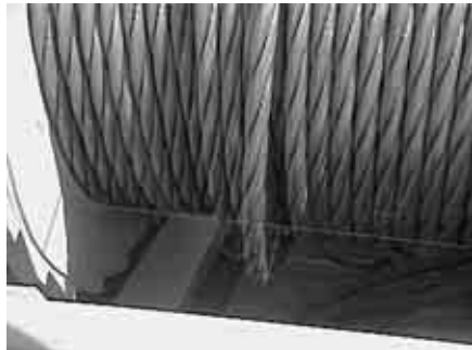
写真3 急停止時のロープの緩み Photo 3 Looseness of wire rope at rapid operation
