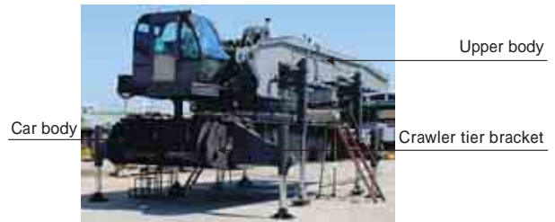
写真2 カーボディの外観 Photo 2 Appearance of car body
