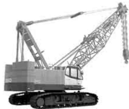
写真1 移動式クレーン(クローラークレーン) Photo 1 Mobile crane (Crawler crane)
