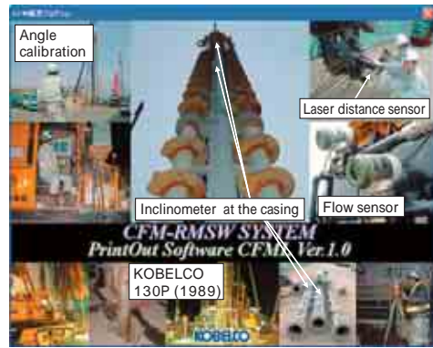
図8 3軸オーガアタッチメントを取付けた130Pへの施工管理システム装着事例 Fig. 8 Execution management system of 130P
