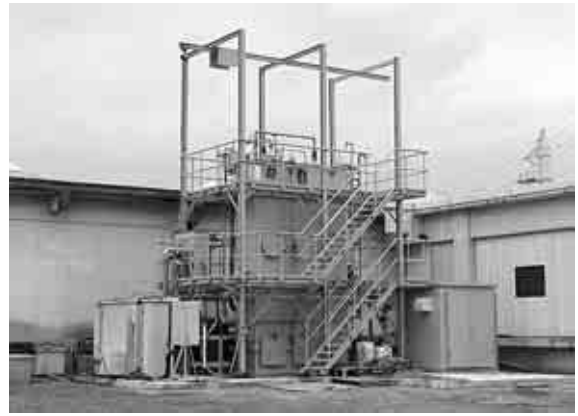
写真3 中空糸膜分離活性汚泥法パイロットテスト装置 Photo 3 Pilot scale equipment of hollow fiber membrane
