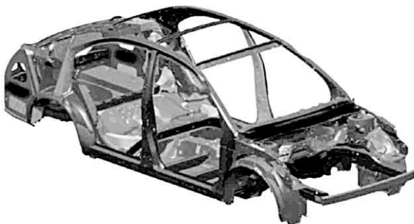
図2 比較車両の車体構造
