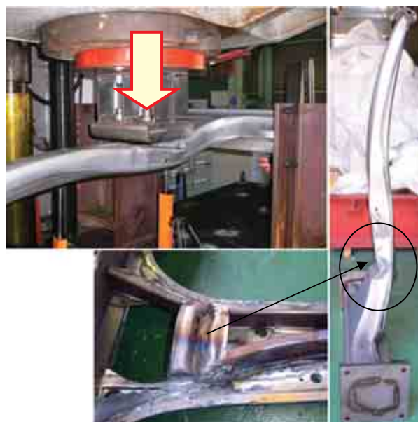
写真1 センタピラーの圧壊試験および試験後の座屈状態 Photo 1 Center-pillar collapse test device and deformation of center-pillar after the test
