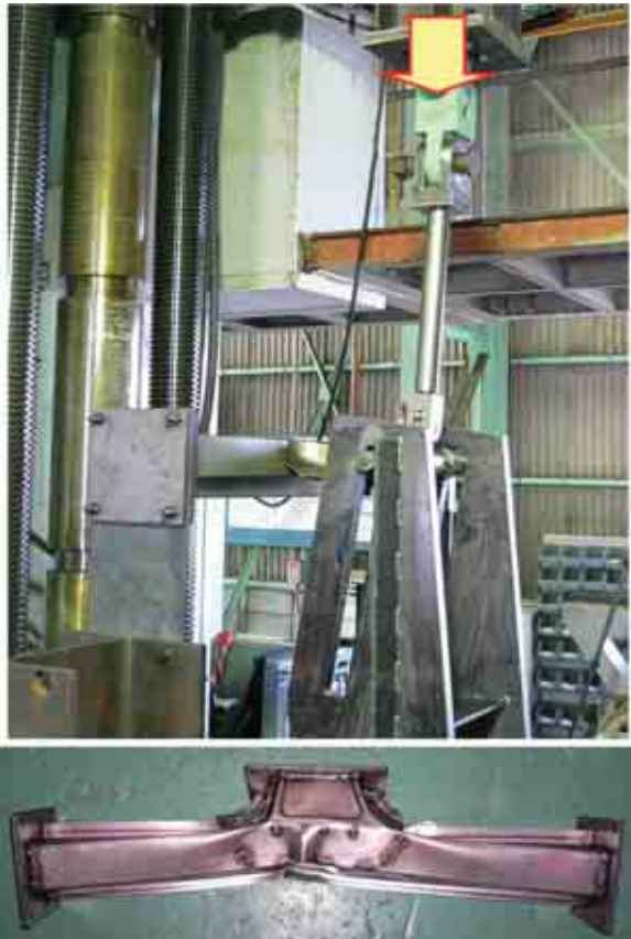
写真2 サイドシルの圧壊試験および試験後の座屈状態 Photo 2 Side sill collapse test device and deformation of side sill after test
