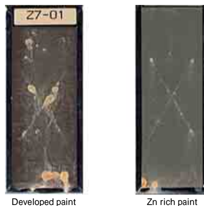
写真3 CCT-JASO90 サイクル後の外観写真
