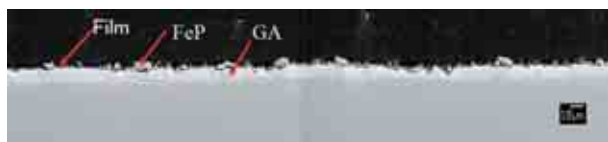
写真2 50%FeP 添加塗装鋼板の断面 SEM 像
