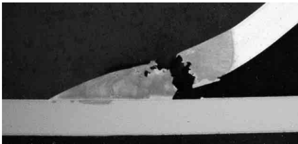
写真4 ピール試験における破断位置 (溶接速度 160cm/min)
