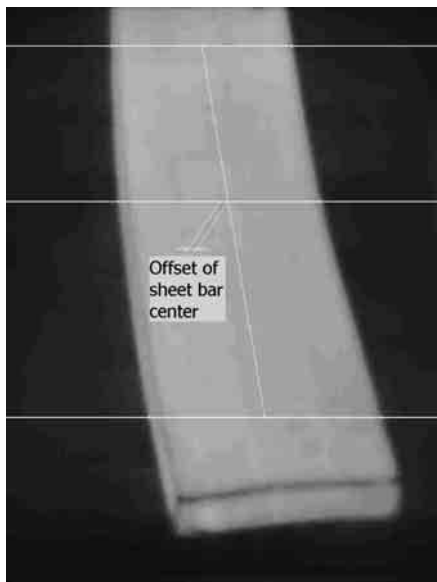
図9 キャンバの計測方法 Fig. 9 Method to measure sheet-bar camber
