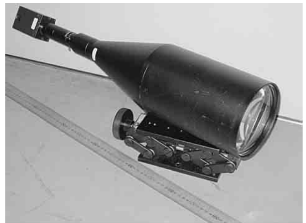
図1 テレセントリックレンズと高分解能カメラ Fig. 1 Telecentric lens and high resolution camera
