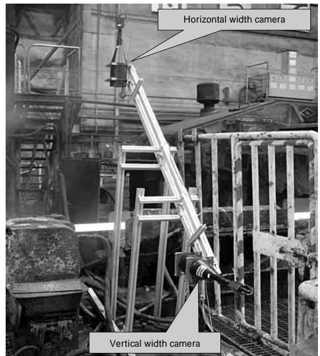
図7 線材熱延ラインでの材幅測定実験 Fig. 7 Hot work width measurement at hot wire mill
