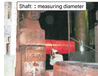
図1 鍛造中の形状確認作業
