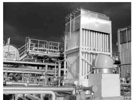
図 3 SUPERAFV 外観 (気化器本体 + 消霧装置)
