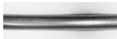
図1 抗菌めっきステンレス鋼線の外観
