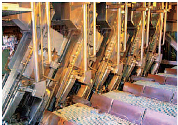
図 8 同一線上配置の切断機 Fig. 8 Shear arranged on straight line
