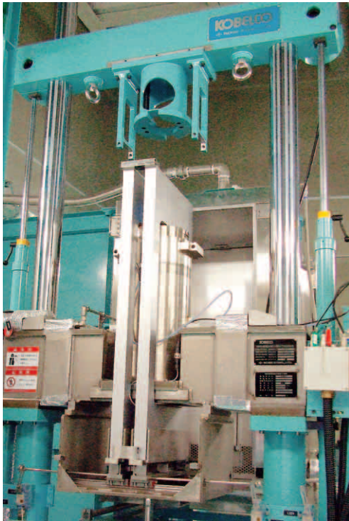
図10 高圧水素試験機本体外観
