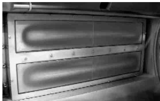
図7 DMS(デュアルマグネトロンスパッタ)蒸発源(500mm 幅) Fig. 7 Dual magnetron sputter cathode (500mm wide)
