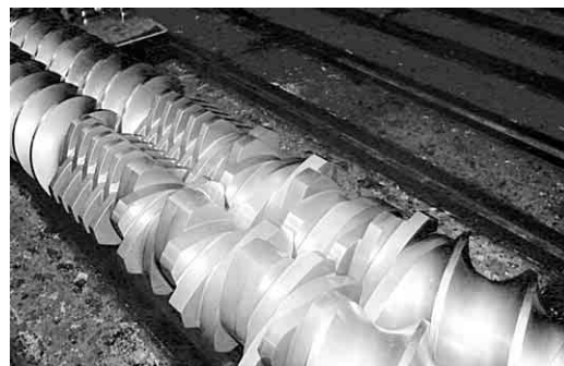
図4 二軸押出機のスクリュ形状 Fig. 4 Screw configuration of twin-screw extruder
