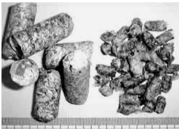
図7 リサイクルペレット Fig. 7 Pellet of recycled plastics
