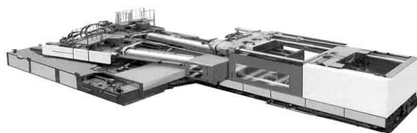
図8 リサイクルサンドイッチパレット成形機 Fig. 8 Sandwich injection molding machine for pallet
