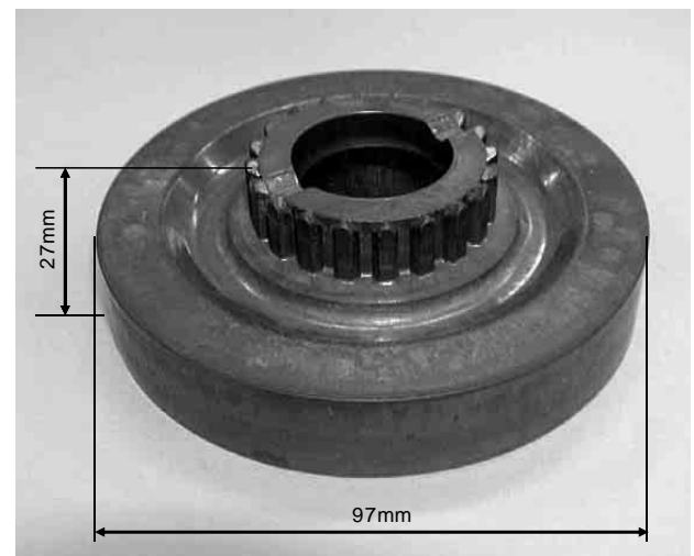
図10 KS EL-Fを用いて1ヒートで型打鍛造した鍛造品例 - 2 - (自動車歯車部品)
