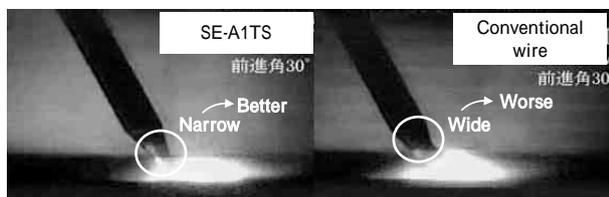
図13 パルス溶接法におけるSE-A1TSと従来ワイヤの溶滴離脱性の比較
