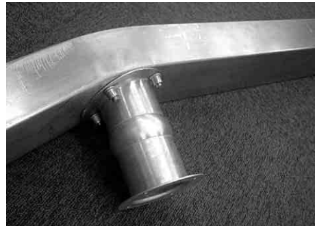
図9 バンパステイへの適用例 Fig.9 Example of electromagnetic flaring for bumper stay
