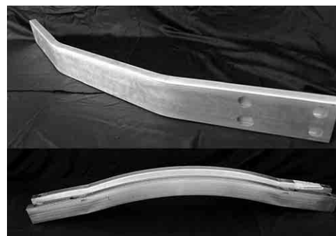
図5 代表的なバンパビーム曲げ形状 Fig. 5 Typical bending shape of bumper beam
