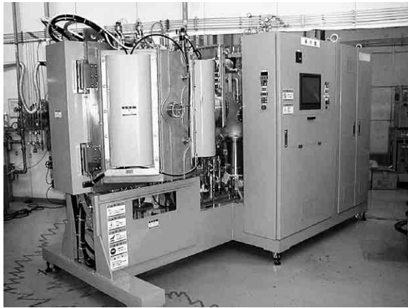
図 8 UBMS 中型生産装置 / UBMS504 Fig. 8 UBMS middle scale production model / UBMS504
