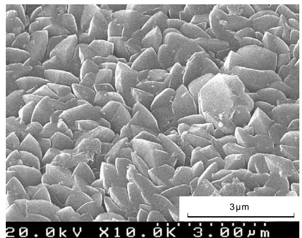
図10 PVD アルミナ皮膜表面の SEM 像 Fig.10 SEM image of PVD Al 2 O 3 film
