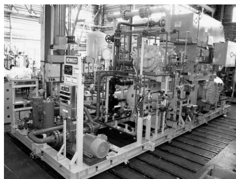
図7 ガスタービン燃料用ガス圧縮機ユニットの外観
