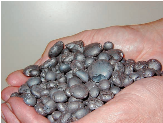
図7 アイアンナゲット外観 Fig. 7 Iron nugget shape
