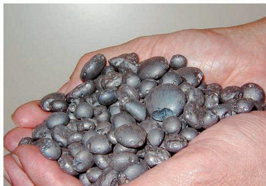
図12 アイアンナゲット Fig.12 Iron nugget product
