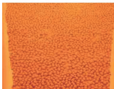
(b) 回転炉床炉内(還元ゾーン)の様子 (b) Inside views of RHF (reduction zone)
