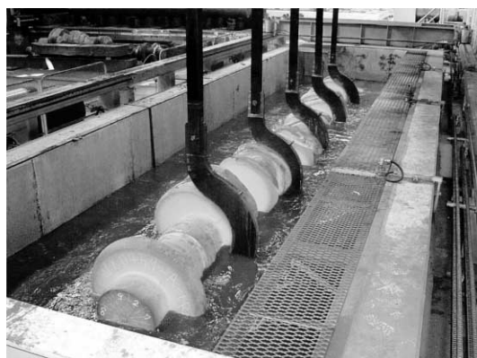
図7 ポリマー焼入れタンクにおいて焼入れを開始する一体型クランク軸
