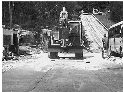
図4 ラフロード走行試験 Fig. 4 Rough road traveling test
