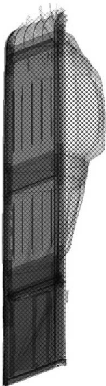
図7 背板の変形モード Fig. 7 Mode shapes of rear panel
