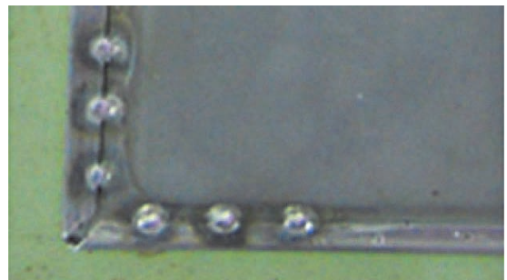
図11 FCWによる試験体の異材接合部
