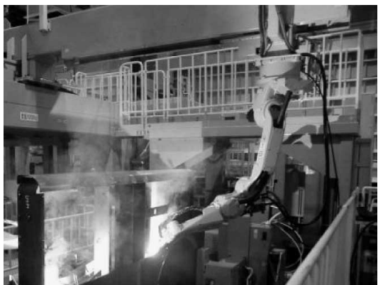
図2 ケーブル内蔵ロボットを用いた建設機械溶接システム Fig. 2 Welding system using a robot with built-in cable for construction machinery
