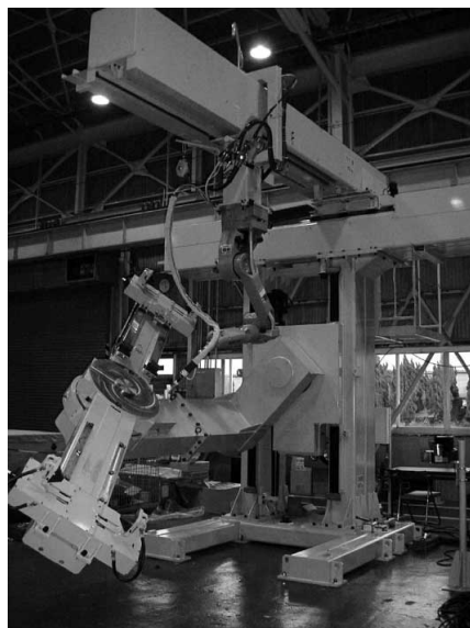
図3 ポジショナ・スライダ一体型溶接システム Fig. 3 Integrated welding system with slider and positioner
