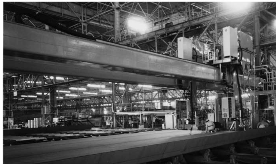
図7 片面サブマージアーク溶接装置 Fig. 7 Equipment for one-side submerged welding
