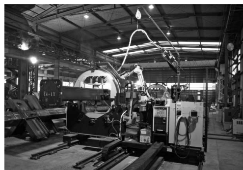
図17 REGARC搭載柱大組立溶接システム
