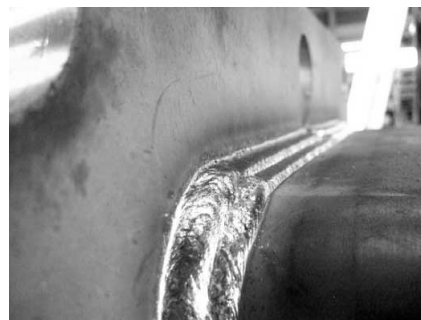
図18 REGARC搭載柱大組立溶接システムによる鉄骨柱溶接後のスパッタ付着状況
