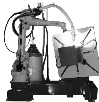
図8 REGARC搭載省スペース型コア・仕口兼用溶接システム
