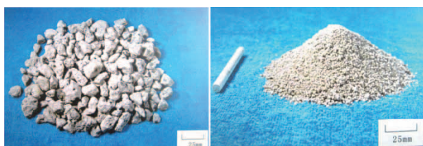
(a) 徐冷スラグ (b) 水砕スラグ (a) Air-cooled blast furnace slag (b) Granulated blast furnace slag
