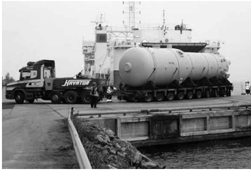
図7 蒸気発生器の輸送 *1) Fig. 7 Transportation of steam generator *2)
