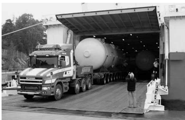
図2 船から陸揚げされる蒸気発生器 *1)
