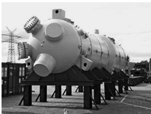
図1 原子力プラントから切り離された蒸気発生器 *1)
