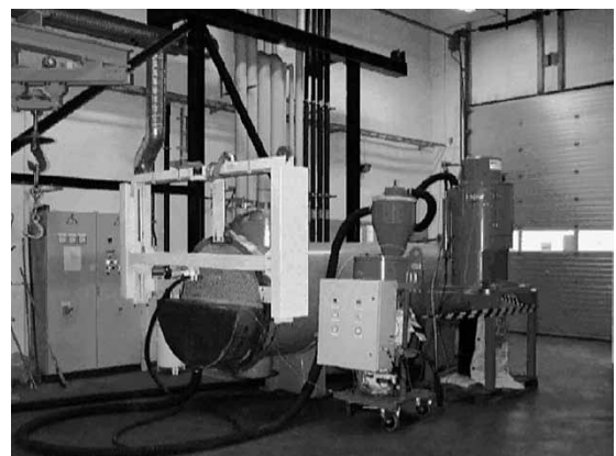
図3 蒸気発生器専用の除染装置 *1)
