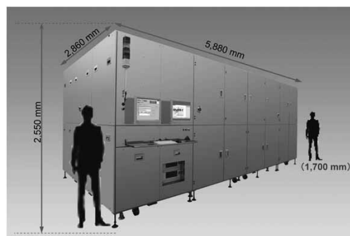
図1 酸化物半導体薄膜評価装置 (LTA-2850SPHIIB: 基板サイズ8.5世代)
