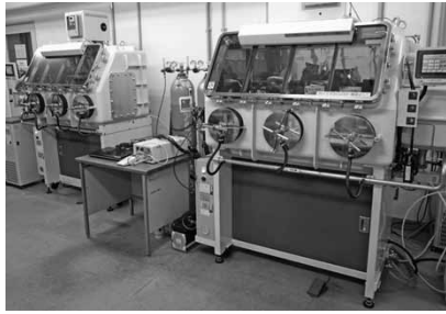
図1 電池解体用グローブボックスの外観 Fig. 1 Grove box for disassembling lithium ion battery cell
