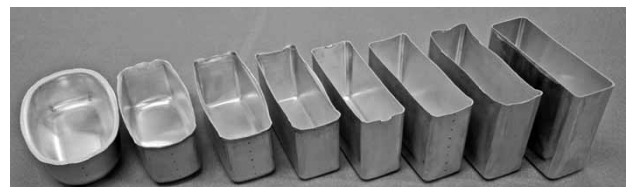
図3 電池ケースの加工工程順プレス品(絞り+しごきの多段加工)の一例
