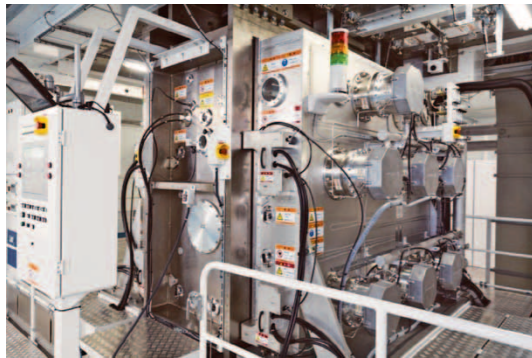
図1 W50-1300S型R2R装置ベースチャンバ部の外観 Fig. 1 Base chamber of sputter R2R model W50-1300S
