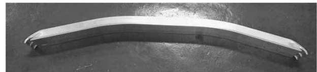
図6 両端部が成形されたバンパビーム Fig. 6 Both-ends-formed bumper beam
