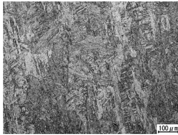
図8 光学顕微鏡による溶接金属（溶接まま）のマイクロ組織 Fig. 8 Optical microstructure of weld metal as welded condition
