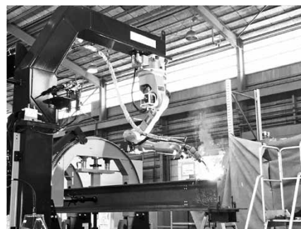
図4 鉄骨H柱溶接ロボットシステム Fig.4 Structural steel welding robot system for H column
