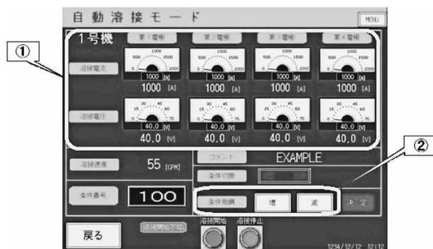
図5 マルチオペレーション機能画面 Fig. 5 Multi-operation function reference screen
